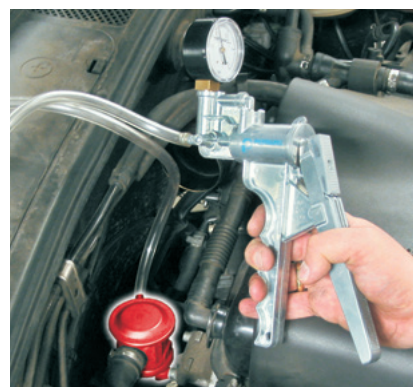
Examen d'une valve d'air secondaire au moyen d'une pompe à dépression manuelle
