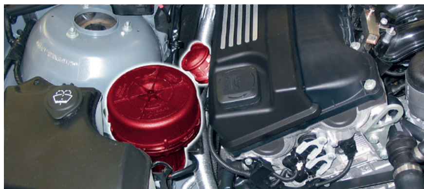
Valve d'air secondaire et pompe d'air secondaire sur une BMW E46 (en rouge)
