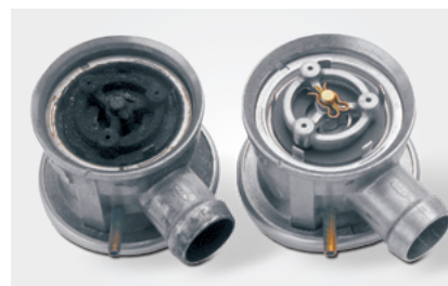
Valve d'air secondaire ouverte à gauche : détérioration par condensat de gaz d'échappement à droite : neuf
