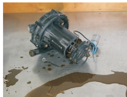
Condensat de gaz d'échappement liquide s'écoulant d'une pompe d'air secondaire
